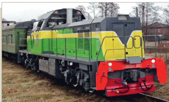
• Маневровый тепловоз ТЭМ9-Н (Sinarahybrid) с гибридной установкой
